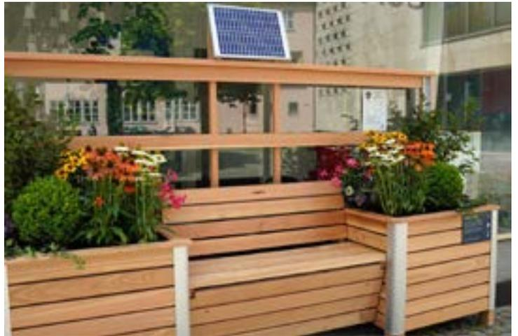
Das „autarke Hochbeet“ vor dem Weinhof 9 bewässert sich je nach Feuchtigkeit der Erde automatisch. Die Messung der Bodenfeuchtigkeit wird über Tensiometer geregelt, die - ähnlich wie Pflanzen selbst - über die Saugspannung den Wassergehalt im Boden bestimmen.
